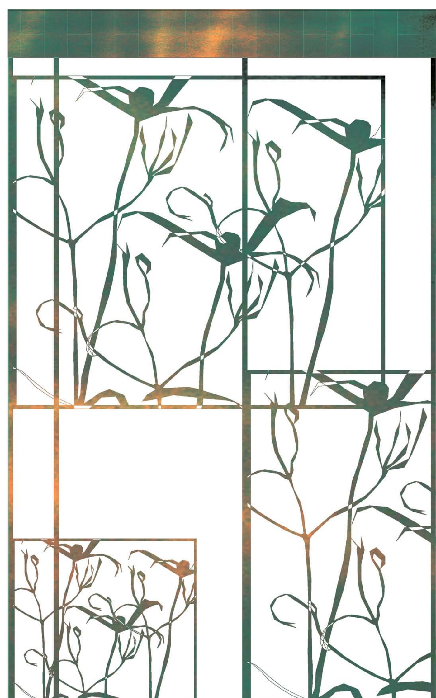
Skärm - en stilliserad clematis av utstansad kopparplåt monterad på kopparrör, 1:50
